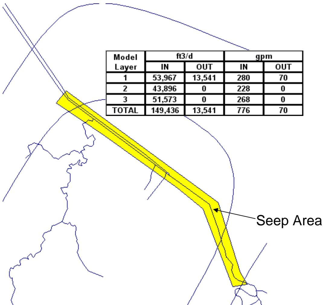
**Figure 7.10. Model-Predicted Seep Discharge**
